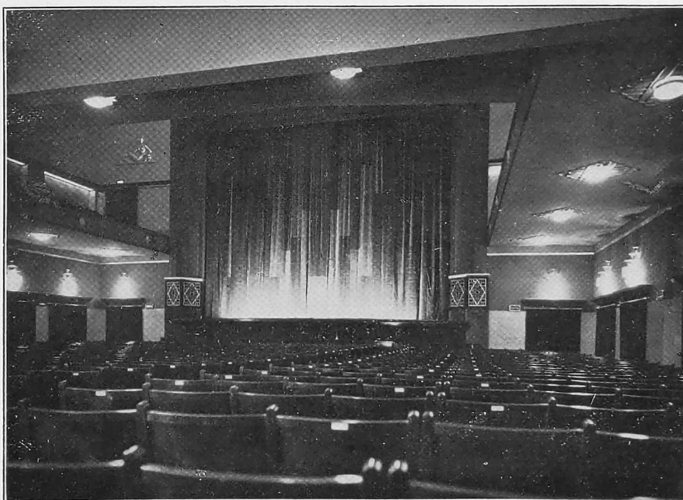
Veduta dalla platea del boccascena a velario chiuso. Il velario è in velluto striato bleu freddo; La sua decorazione è ottenuta congiungendo le varie tele a pelo rovesciato. Si notano nei fianchi del boccascena le griglie argentate delle bocche di ricupero dell'aria calda.
