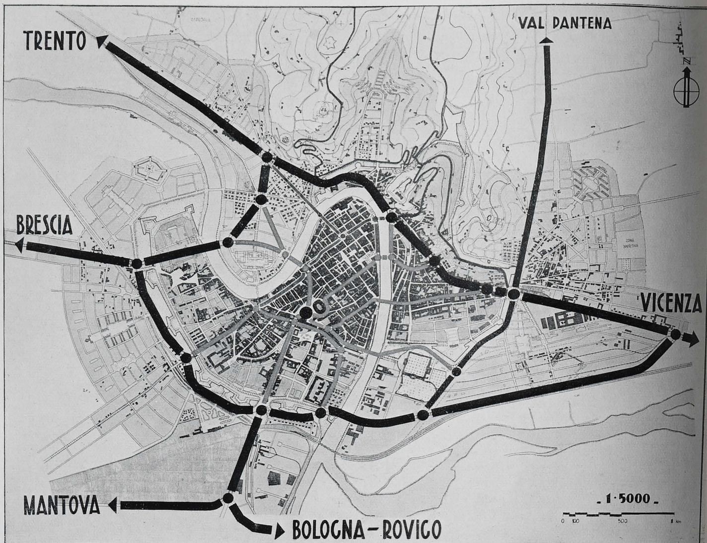
PROGETTO ING. CHIODI E ARCH. MERLO. - PROGETTO PRESENTATO AL CONCORSO PER IL PIANO REGOLATORE DI VERONA. - PRIMO PREMIO EX AEQUO. - SCHEMA DELLE VIE PRINCIPALI DI COMUNICAZIONE.
